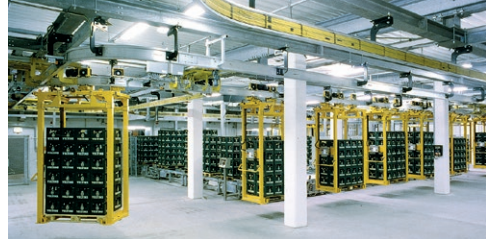
シングルフレックスライン0811 醸造所の電動モノレールシステム
