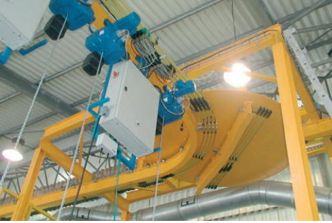
シングルパワーライン0812 メッキ工場 ターニングゲート上の橋形エ レメントに取付 ダブルコレクタアッセンブリ
