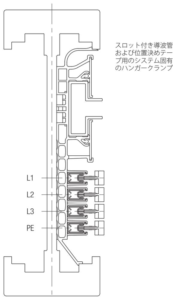
スロット付き導波管および位置決めテープ用のシステム固有のハンガーランプ
